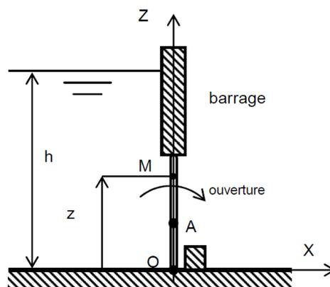
Les lois de l'hydrostatique donnent  $p_{(M)} = \rho_e g (h - z_{(M)})$  avec  $\rho_e$  la masse volumique de l'eau, considérée comme constante, et  $(h - z_{(M)})$  la profondeur du point  $M$ .
