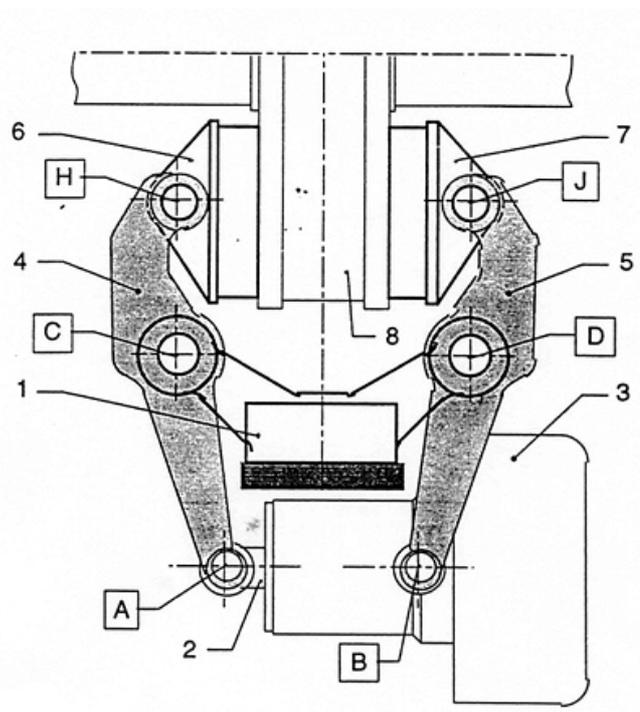
Connaissant la pression de contact entre les plaquettes et le disque (considérée comme uniforme :  $p(M) = p_0$ , avec  $p_0$  constante), l'objectif est ici de déterminer le modèle local des actions mécaniques exercées par la plaquette (6) sur le disque (8).
