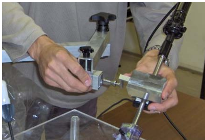
Fig. 6. Connexion du zoom au bras articulé .
