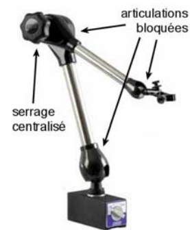
FIGURE 7.3 – Support à serrage centralisé
