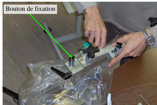
Fig. 3. Fixation du bras sur la nacelle.
